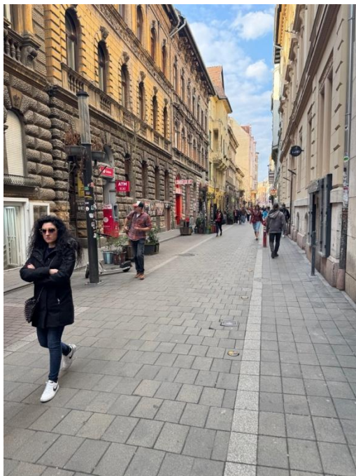
29. ábra A Kazinczy utca szintbe hozott burkolatú, planténerekkel határolt szakasza: a fizikai kialakítás egyértelműen gyalogos elsőbbségű teret jelez. (forrás: saját felvétel, 2026. március)
